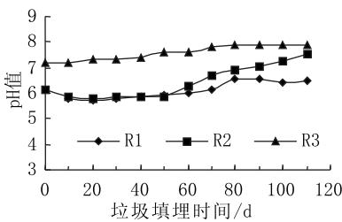
R1—对照实验;R2—渗滤液回流型生物反应器填埋场;R3—两相型生物反应器填埋场系统
