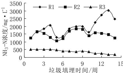
R1—对照实验;R2—渗滤液回流型生物反应器填埋场;R3—两相分离型生物反应器填埋场系统
