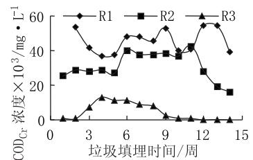
R1 - 对照实验; R2 - 渗滤液回灌型生物反应器填埋场; R3 - 两相分离型生物反应器填埋场系统
