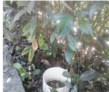
图2 氨挥发收集装置及放置位置
