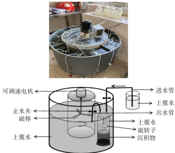
图2 室内培养系统及装置示意图<sup>[21]</sup>
