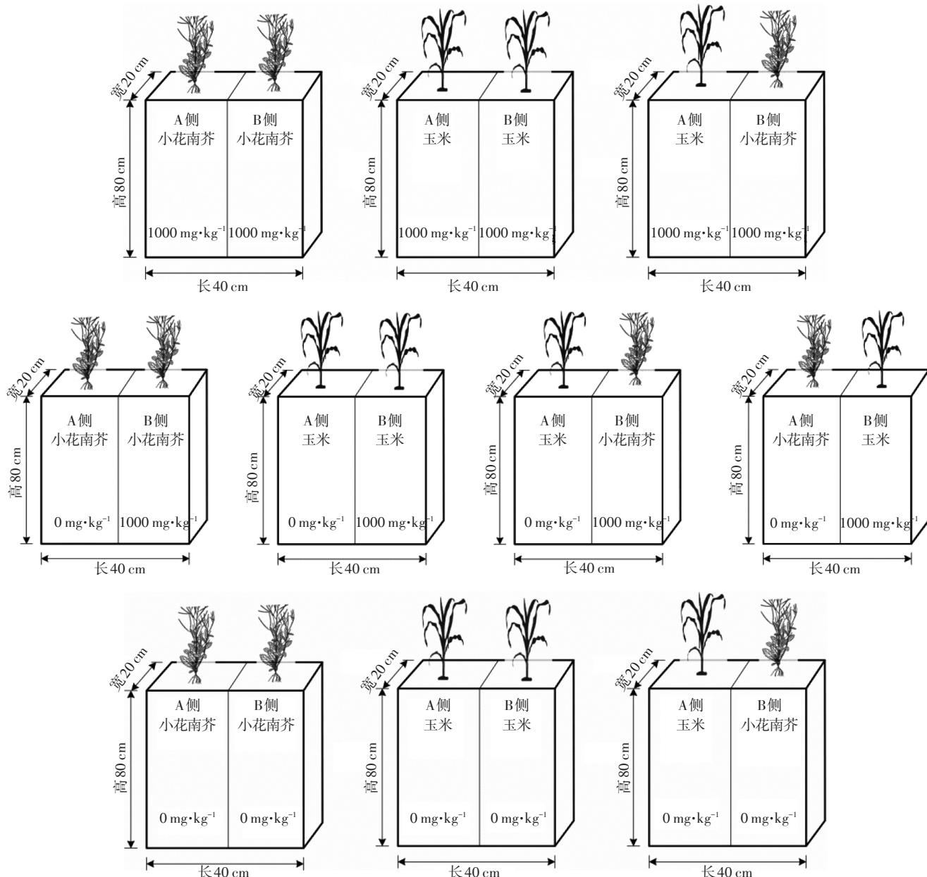
图1 土培试验装置
